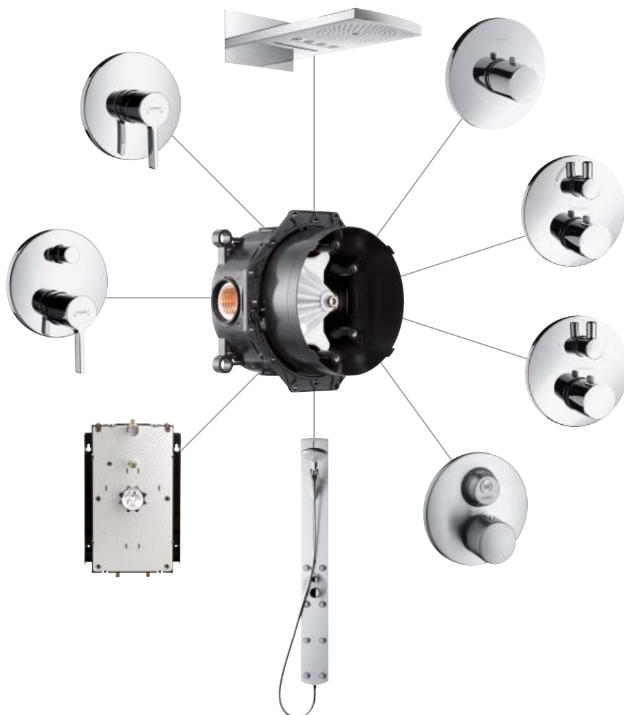
Egykaros falsík alatti kádöltő- és zuhanycsaptelep M3 kerámiabetéttel, átfolyási teljesítmény 3 bar-nál: kádöltés: 31l/perc, zuhany: 24l/perc Egykaros falsík alatti kádöltő- és zuhanycsaptelep biztonsági szerelvény
