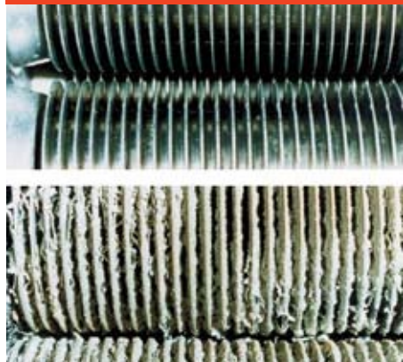
Alumínium roncsolódás vizsgálat, 3000 órás üzem
