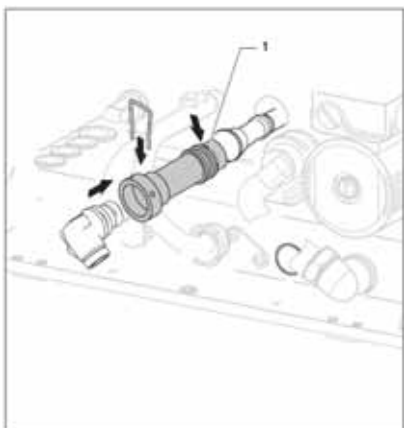
4.11 ábra Összekötő csővezeték beépítése
